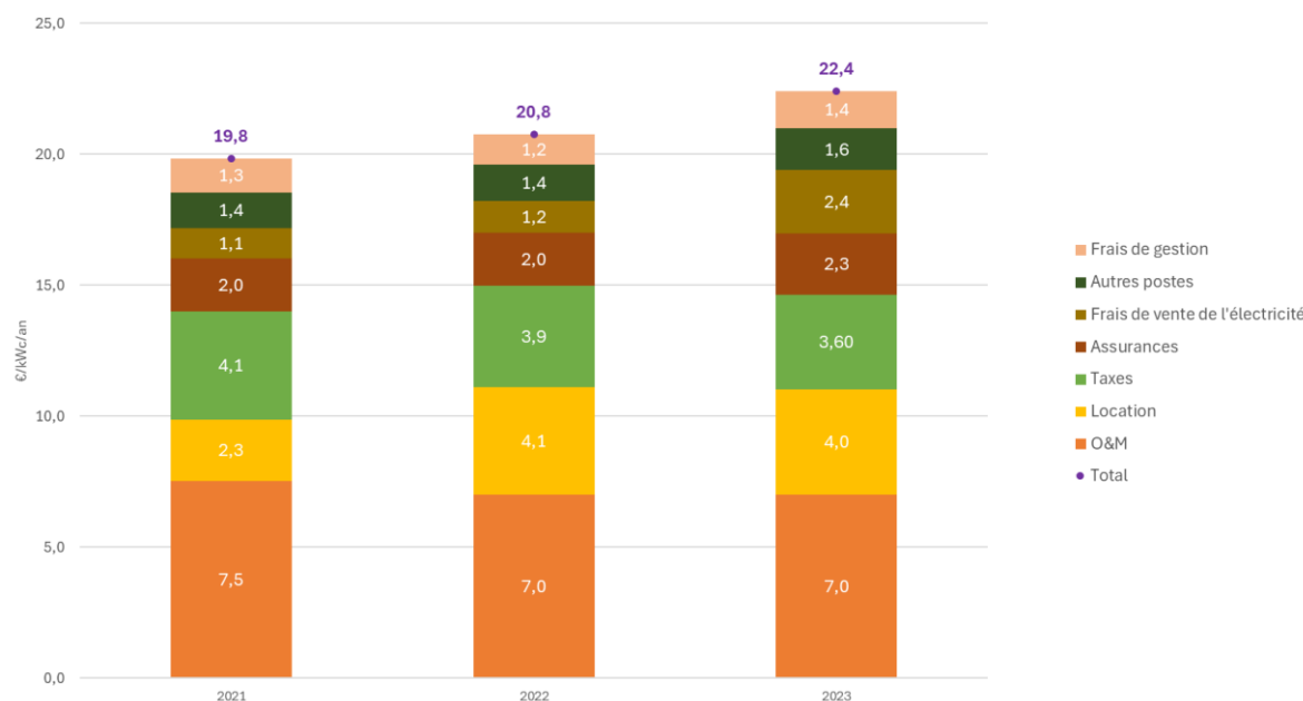
Figure 81 : Evolution de la répartition des OPEX des installations retenues à l'appel d'offres PPE2 – PV Bâtiment
